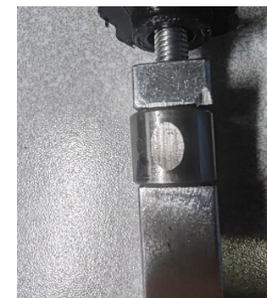
Рисунок 2 – Фотография износа детали подшипника после эксперимента.
